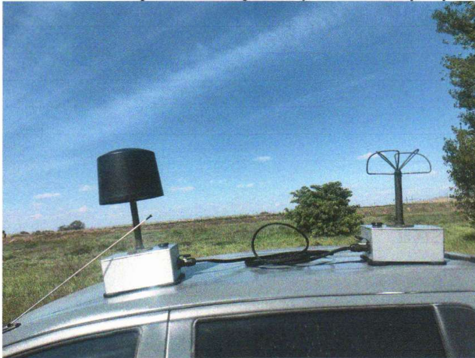
Фото-1. Система протидії FPV-дронам купольного типу «Кульбаба-150»
